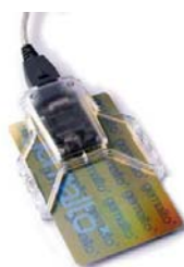
Slika 17. Primjer čitača pametne kartice sa kontaktom
