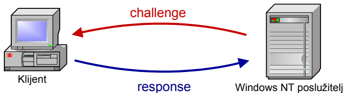
Slika 2: LM/NTLM/NTLMv2 postupak autentikacije
