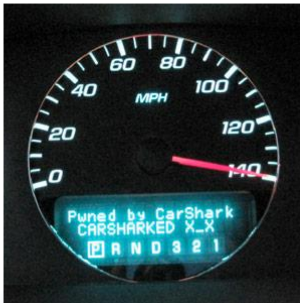
Slika 5. Prikaz proizvoljne poruke i lažno očitavanje brzinomjera Izvor: popularmechanics.com
